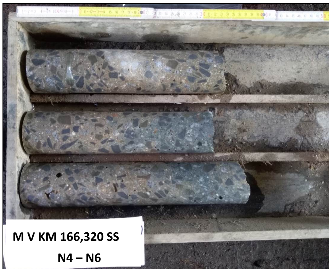
Obr. č. 2 - diagnostické návrty do horní části spodní stavby N4 a N6
