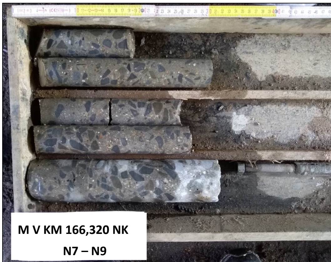
Obr. č. 3 - diagnostické návrty do nosné konstrukce N7 – N9
