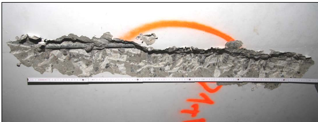
Obr. č. 10 - detailní pohled do sondy SNK1, provedené pro ověření hlavní tahové výztuže ve spodním líci NK, levé části
