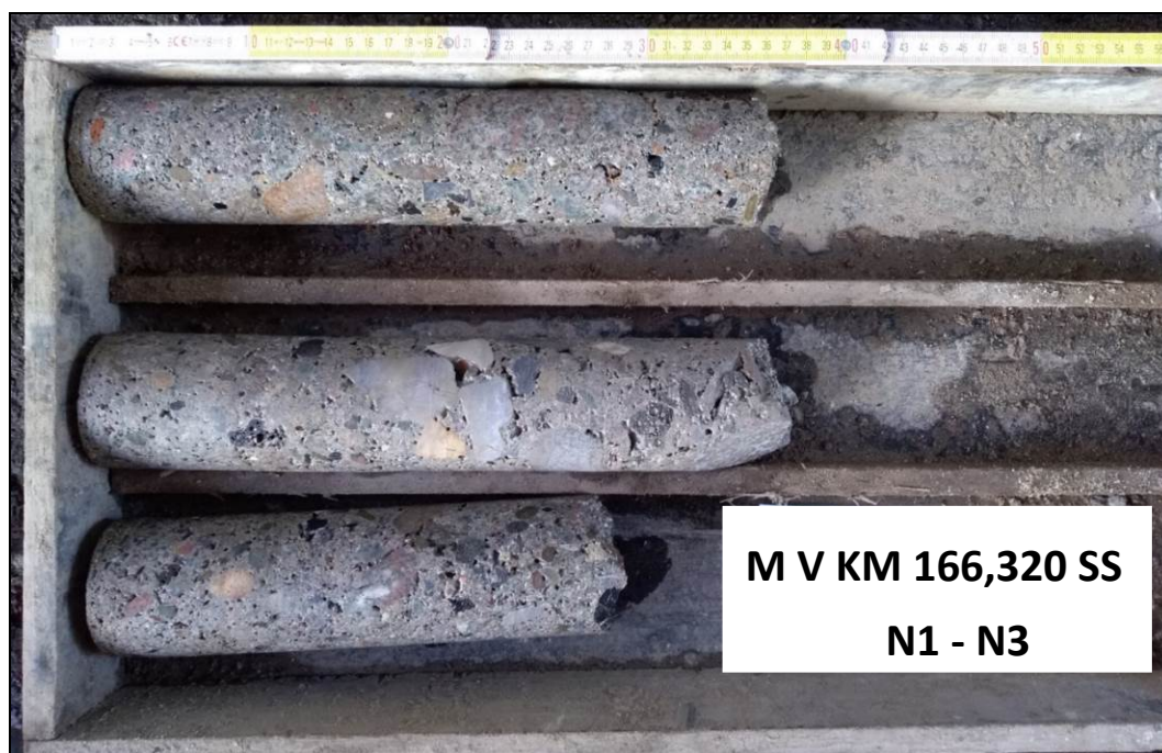
Obr. č. 1 - diagnostické návrty do spodní části spodní stavby N1 - N3
